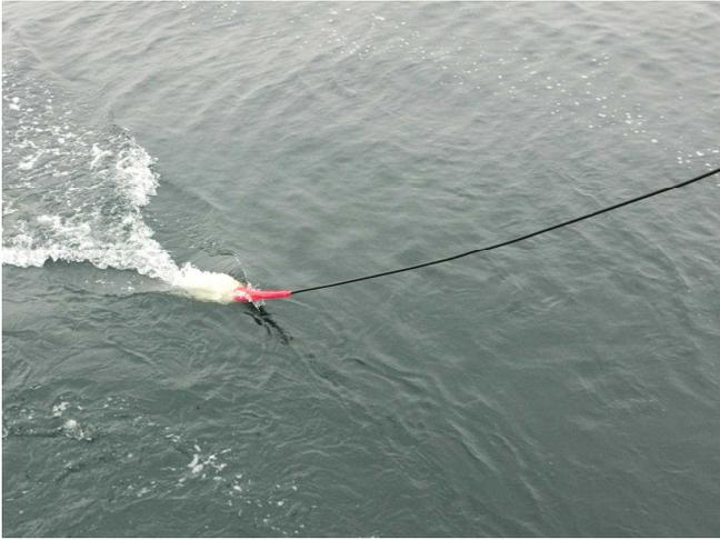
プロトン磁力計（後方に150m曳航）
