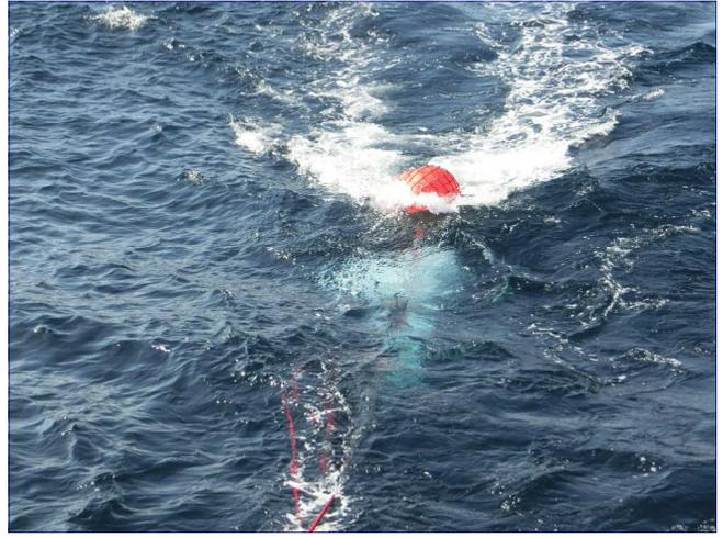
エアガンによる人工地震の発生（水中の泡参照）
