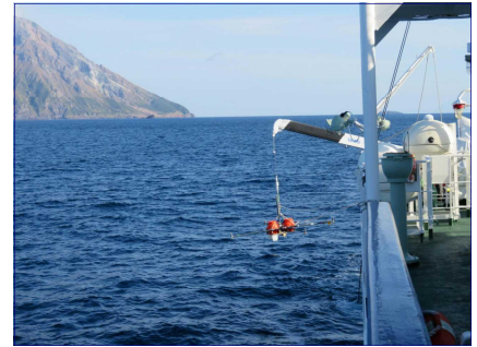
海底電位磁力計の海底設置
