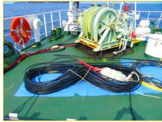
プロトン磁力計(曳航長さ150m)
