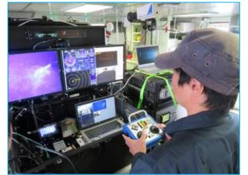
海底のROVの遠隔操縦
