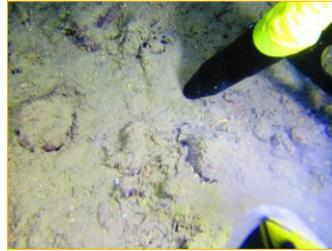
ROVによる底質物の採取(水深205m付近)
