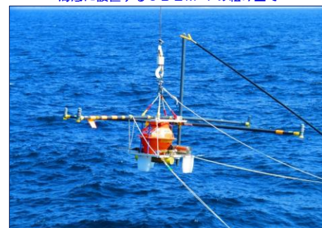
OBEM-7の海底設置(水深480メートル)
