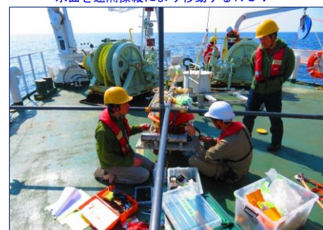
海底に設置するOBEM-7の組み立て
